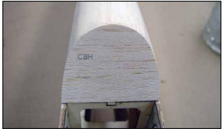
Install cockpit bulkhead CBH to E1
